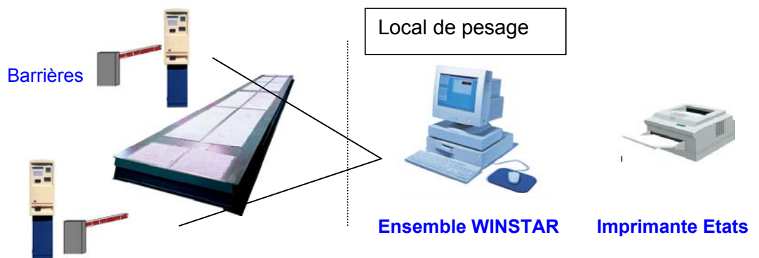
Exemple de configuration d'un pont bascule, deux bornes « Sentinelle » et deux barrières
